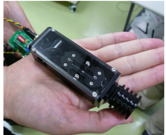
図7 超小型のミラーレス THz 後進波パラメトリック発振器：模式図（左）と試作モジュール（右）[8]
