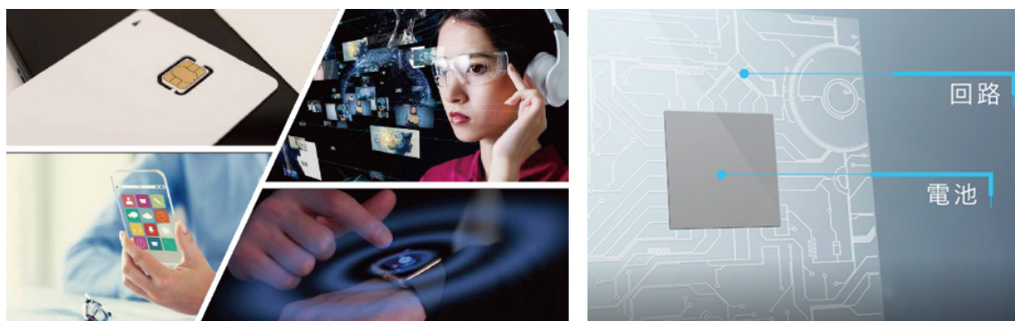
図 4 IoT 時代が新たに要求する電池は多種多様な薄型・小型形状 (左:イメージ) で、集積電子回路の一部として組み込まれる (右)
