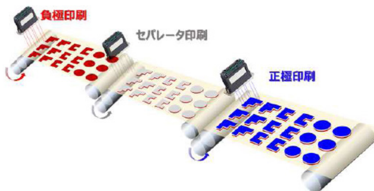
図 6 RtoR デジタル印刷による任意形状の負極活物質/セパレータ/正極活物質積層体を RtoR で連続して形成する製造法
